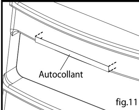
11- Apposer l'autocollant sur l'échelle pivotante de façon à ce qu'il soit bien visible. (fig.11)
