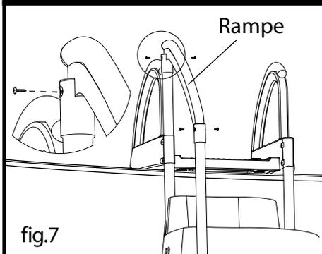
7- Fixer la rampe sur les tubes supports à l'aide des vis 3/4" (2). (fig 7)
